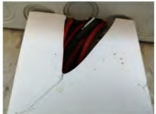
Рисунок 6.2. Ризик пошкодження ізоляції кабелів.
